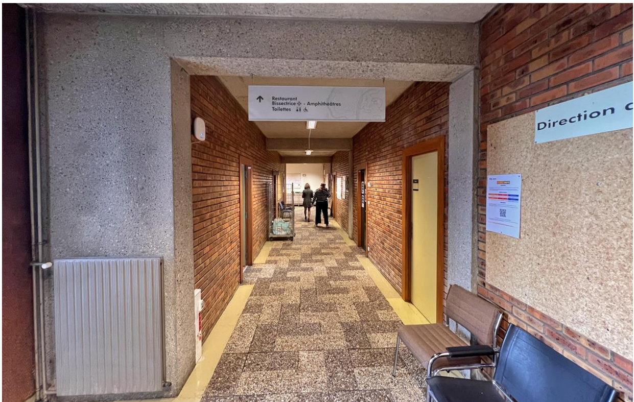
Bâtiment T - Voile de refend en béton percé, cloisons en brique
